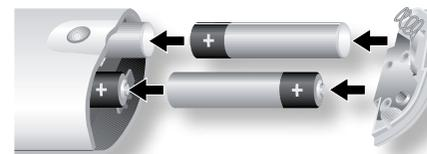
2. Legen Sie vier „AAA“-Batterien in das Batteriefach ein - zwei nach oben, zwei nach unten, wie in der Abbildung.
