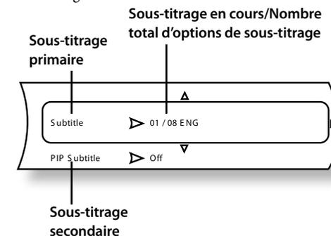
Surlignez la sélection de sous-titrage primaire (Sous-titres) ou secondaire (sous-titrage PIP) à l'aide des boutons **▲/▼**.
