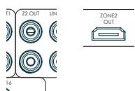
Le connecteur Z2 sortie HDMI peut être utilisé pour connecter la sortie du récepteur à un système situé dans une deuxième pièce.
