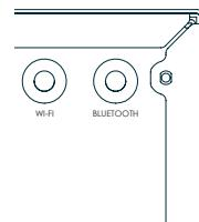
Wenn Sie die WLAN- oder Bluetooth-Funktionen des Receivers benutzen möchten, dann montieren Sie bitte die Bluetooth-Antenne und die beiden WLAN-Antennen an den Receiver.
