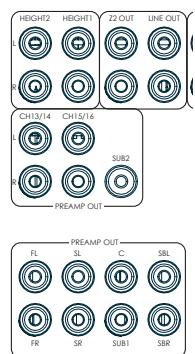
Tutte le uscite analogiche del preamplificatore hanno un buffer, hanno una bassa impedenza di uscita, sono a livello di linea e seguono l'impostazione del controllo del volume della Zona 1. Sono in grado di usare cavi lunghi o più ingressi in parallelo se necessario.
