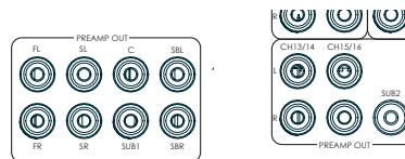
接收器还支持将最多 4 个有源低音炮连接到 SUB 或 Ch13/14/15/16 输出接口。请参阅低音炮的手册，以了解特定低音炮的正确设置与连接步骤。
