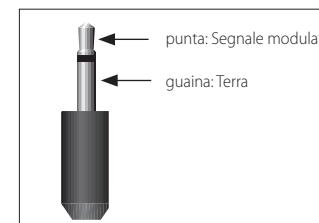
Gli ingressi infrarossi (**Z1 IR** e **Z2 IR**) consentono il collegamento di ricevitori IR esterni, sia quando il ricevitore IR sul pannello anteriore del ricevitore è completamente o parzialmente ostruito o per consentire l'utilizzo di un telecomando in Zona 2.
