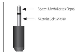
Die Infraroteingänge (**Z1 IR** und **Z2 IR**) ermöglichen Ihnen den Anschluss eines externen IR-Empfängers für den Fall, dass entweder der IR-Empfänger des Receivers an der Gerätewordseite vollständig oder teilweise verdeckt ist oder um die Möglichkeit zu erhalten, die Fernbedienung in Zone 2 zu benutzen.
