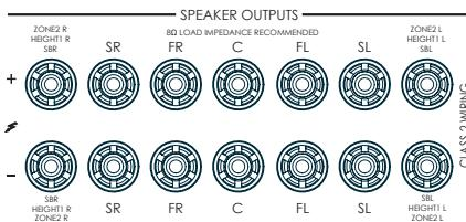
Losse geleiderdraden van deze aansluitingen mogen andere kabels of de behuizing van het product niet raken. De niet-inachtneming van deze aanwijzing kan kortsluiting en schade aan uw ontvanger berokkenen.
