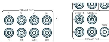
Il ricevitore consente di collegare fino a quattro subwoofer attivi alle uscite **SUB** o **Ch13/14/15/16**. Consultare il manuale del subwoofer per la corretta impostazione e la procedura di collegamento per il vostro particolare subwoofer.
