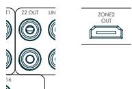
Z2 out HDMI 连接器用于将接收器输出连接到位于另一个房间的系统。
