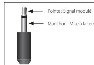
Les entrées infrarouges (**Z1 IR** et **Z2 IR**) permettent la connexion de récepteurs IR externes, soit lorsque le récepteur IR du panneau avant de le récepteur est complètement ou partiellement obstrué, soit pour permettre l'utilisation d'une télécommande dans la zone 2.
