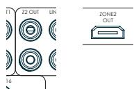
De Z2 Uit HDMI-connector kan worden gebruikt om de uitgang van de ontvanger aan te sluiten op een systeem geplaatst in een tweede kamer.
