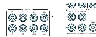
L'amplificateur offre également la possibilité de brancher jusqu'à quatre caissons de graves actifs sur SUB ou sur les CH13/14/15/16 sorties. Consultez le manuel de votre caisson de graves pour connaître la procédure appropriée de configuration et de branchement pour votre modèle précis de caisson de graves.
