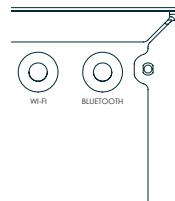
Als u de WiFi- of Bluetooth-functies van de ontvanger wilt gebruiken, bevestig dan de enkele antenne voor Bluetooth en de twee antennes voor WiFi.
