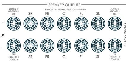
È importante che nessun filo vagante proveniente da questi collegamenti possa toccare un altro cavo o la custodia del prodotto. L'incapacità di garantire questa condizione può causare un cortocircuito e danneggiare il ricevitore.
