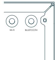
In caso di utilizzo delle funzioni Wi-Fi o Bluetooth del ricevitore, applicare l'antenna unica per il Bluetooth e le due antenne per il Wi-Fi.
