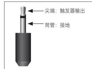
只要将接收器打开并启用相关区域，触发器连接器（TRIG Z1 和 TRIG Z2）就会提供电信号。
