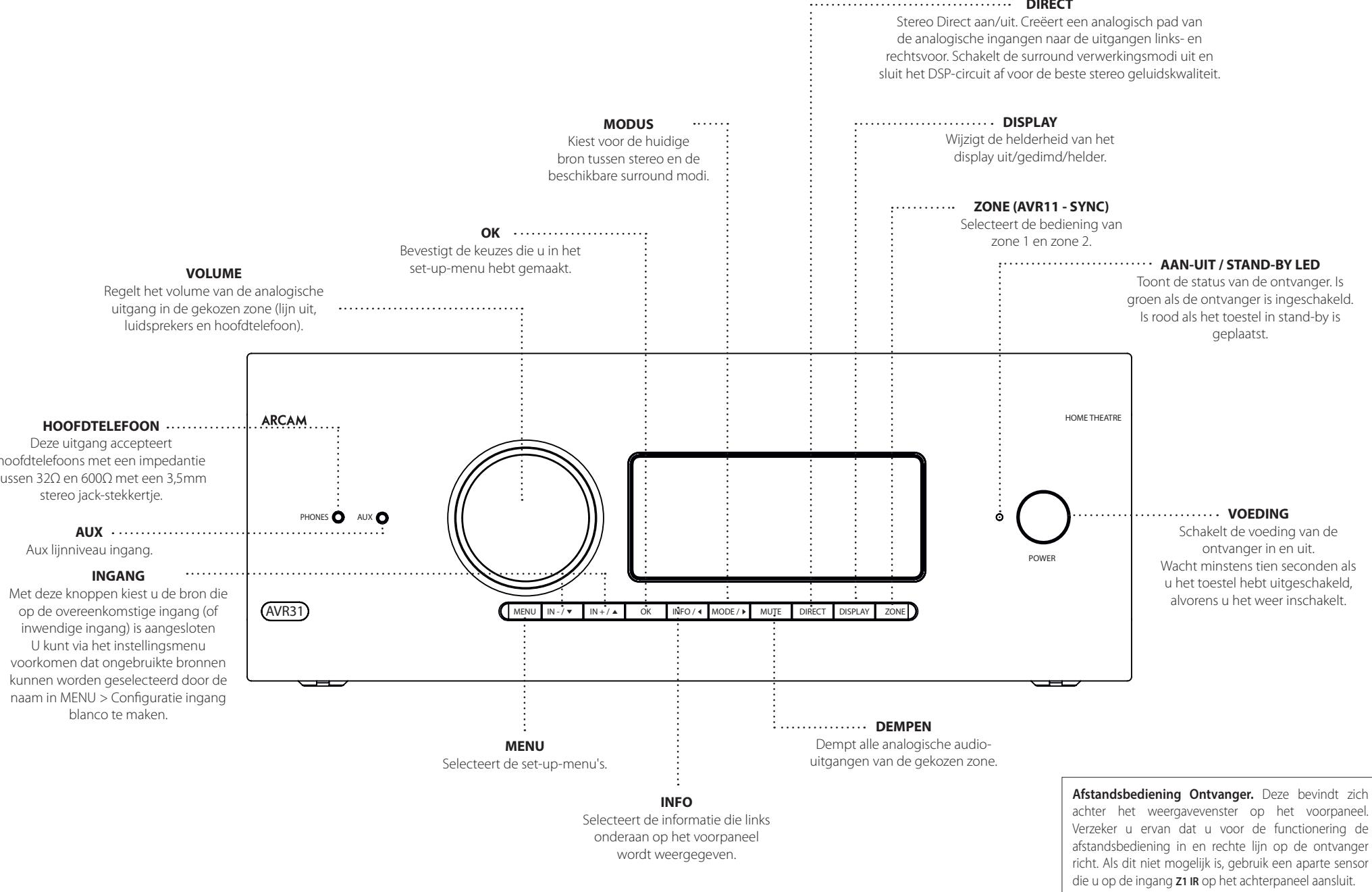
**Afstandsbediening Ontvanger.** Deze bevindt zich achter het weergavevenster op het voorpaneel. Verzekер u ervan dat u voor de functionering de afstandsbediening in een rechte lijn op de ontvanger richt. Als dit niet mogelijk is, gebruik een aparte sensor die u op de ingang **Z1 IR** op het achterpaneel aansluit.
