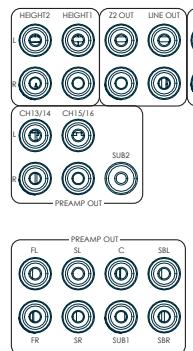
Toutes les sorties analogiques du préamplificateur opèrent en mode tampon, ont une faible impédance de sortie, sont au niveau ligne, et suivent le réglage du volume de la zone 1. Ils sont capables de piloter de longs câbles ou plusieurs entrées en parallèle si nécessaire.
