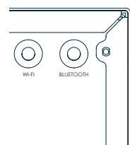
Si vous utilisez les fonctions Wi-Fi ou Bluetooth du récepteur, veuillez fixer l'antenne unique pour le Bluetooth et les deux antennes pour le Wi-Fi.
