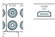
El conector HDMI Z2 out se puede utilizar para conectar la salida del receptor a un sistema en una segunda habitación.
