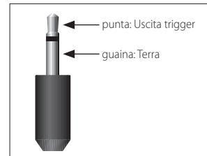
I connettori trigger (**TRIG Z1** e **TRIG Z2**) forniscono un segnale elettrico ogni volta che il ricevitore è acceso e la relativa zona attiva.
