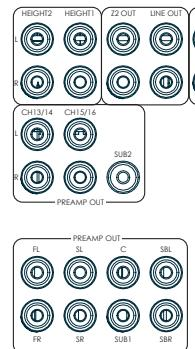
所有前置放大器模拟输出已都经过缓冲，其输出阻抗较低，采用线路电平，并遵照区域1的音量控制设置。如果需要，可以使用这些接口来驱动较长线缆或同时驱动多个输入。
