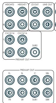
Alle analogen Vorverstärker-Ausgänge sind gepuffert, haben eine geringe Ausgangs-Impedanz, sind auf Line-Pegel und folgen der Lautstärkeinstellung für Zone 1. Sie erlauben die Nutzung langer Kabel oder mehrerer paralleler Eingänge, wenn nötig.
