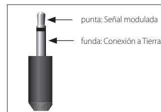
Las entradas infrarrojas (**Z1 IR** y **Z2 IR**) permiten la conexión de receptores IR externos, ya sea cuando el panel frontal del receptor está total o parcialmente obstruido, o bien, permiten el uso de un mando a distancia en la Zona 2.
