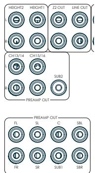
De analogische voorversterker uitgangen zijn gebufferd, hebben lage uitgangsimpedantie, zijn op lijnniveau en volgen de volumeregeling van zone 1. Indien noodzakelijk kunnen ze lange kabels of verschillende parallel aangesloten ingangen aansturen.
