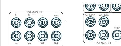
Der Receiver ermöglicht Ihnen zudem, an den Ausgängen **SUB** oder **Ch13/14/15/16** bis zu vier Aktivsubwoofer anzuschließen. Sehen Sie in Ihrer Subwoofer-Bedienungsanleitung nach, um die richtige Einstellung und Verbindung für Ihren speziellen Subwoofer zu wählen.
