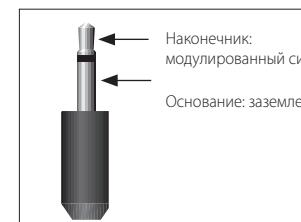
Инфракрасные входные разъемы (**Z1 IR** и **Z2 IR**) позволяют подключать внешние ИК-приемники, когда ИК-приемник на передней панели ресивера полностью или частично закрыт, а также для использования пульта дистанционного управления в Зона 2.
