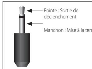
Les connecteurs de déclenchement (**TRIG Z1** et **TRIG Z2**) fournissent un signal électrique chaque fois que le récepteur est mis sous tension et que la zone concernée est activée.
