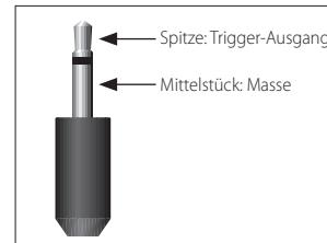
Die Triggeranschlüsse (**TRIG Z1** und **TRIG Z2**) liefern ein elektrisches Signal, wenn der Receiver eingeschaltet und die entsprechende Zone aktiviert ist.
