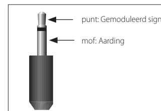
De infrarood ingangen (**Z1 IR** en **Z2 IR**) kunt u gebruiken voor de aansluiting van externe IR-ontvangers als de IR-ontvanger op het voorpaneel van de ontvanger gedeeltelijk of helemaal is afgedekt, of om een afstandsbediening te kunnen gebruiken in zone 2.
