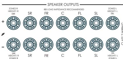
Il est important qu'aucun brin de fil sortant de ces connexions ne touche un autre câble ou le boîtier du produit. Le non-respect de cette précaution peut provoquer un court-circuit et endommager votre amplificateur.
