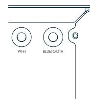
Si utiliza las funciones Wi-Fi o Bluetooth del receptor, instale una sola antena para el Bluetooth y las dos antenas para el Wi-Fi.
