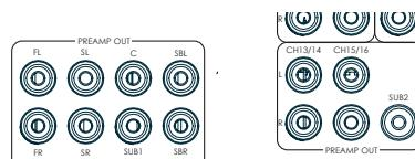
El receptor también permite que se conecten hasta cuatro subwoofers activos a las salidas **SUB** o **Ch13/14/15/16**. Remítase al manual de su subwoofer para saber cuál es la configuración y el procedimiento de conexión correctos para su subwoofer en particular.
