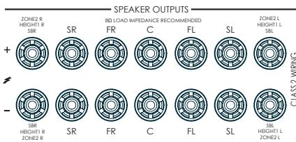
Es ist wichtig, dass keine einzelnen Litzen die Drähte eines anderen Kabels oder das Gehäuse berühren. Nichtbeachtung kann zu Kurzschluss und Beschädigung Ihres Receivers führen.
