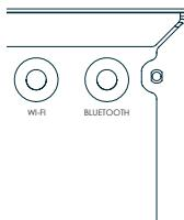
При использовании функций Wi-Fi или Bluetooth ресивера, подключите одну antennу для Bluetooth и две antennы для Wi-Fi.
