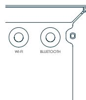
如果使用接收器的 Wi-Fi 或蓝牙功能，请连接单个蓝牙天线和两个 Wi-Fi 天线。
