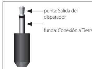
Los conectores de los disparadores (**TRIG Z1** y **TRIG Z2**) brindarán una señal eléctrica en cualquier momento en el que se encienda el receptor y se habilite la zona relevante.
