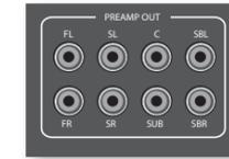
Все аналоговые выходные разъемы предварительного усилителя имеют буфер, низкое выходное сопротивление, линейный вход и управляются настройками уровня громкости Зоны 1. Если необходимо, к ним можно подключить длинные кабели или несколько входных разъемов, подключенных параллельно.
