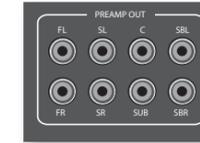
Alle analogen Vorverstärker-Ausgänge sind gepuffert, haben eine geringe Ausgangs-Impedanz, sind auf Line-Pegel und folgen der Lautstärkeinstellung für Zone 1. Sie erlauben die Nutzung langer Kabel oder mehrerer paralleler Eingänge, wenn nötig.
