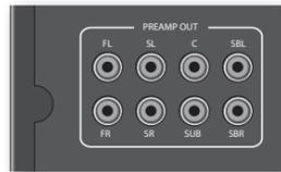
L'AV950/AVR750/450/380 permet également de brancher un subwoofer actif sur la sortie **SUB**. Veuillez consulter le manuel du subwoofer pour connaître la bonne installation et le bon raccordement du subwoofer.
