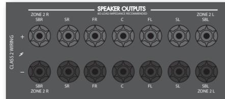
如果主区域包含 5.1 声道环绕声音箱系统（不是 7.1 声道系统），则可以使用备用的 SBL 和 SBR 音箱输出来为区域 2 中的音箱供电，因此不需要功率放大器。
