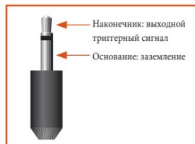
Триггерные разъемы (**TRIG Z1** и **TRIG Z2**) подают электрический сигнал, когда ресивер AV950/AVR750/450/380 включен, а также когда включены соответствующие зоны.
