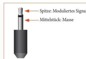
Die Infraroteingänge (**Z1 IR** und **Z2 IR**) ermöglichen den Anschluss eines externen Infrarotempfängers, wenn beispielsweise der Infrarotempfänger des AV950/AVR750/450/380 auf der Gerätefront verdeckt ist, oder um eine Fernbedienung in Zone 2 nutzen zu können.
