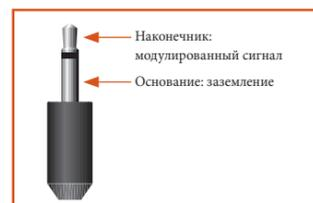
Инфракрасные входные разъемы (**Z1 IR** и **Z2 IR**) позволяют подключать внешние ИК-приемники, когда ИК-приемник на передней панели ресивера AV950/AVR750/450/380 полностью или частично закрыт или для использования пульта дистанционного управления в Зоне 2.
