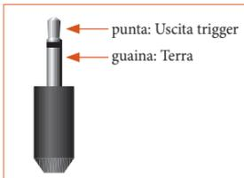
I connettori di trigger (**TRIG Z1** e **TRIG Z2**) forniscono un segnale elettrico ogni volta che l'AV950/AVR750/450/380 è acceso e la relativa zona abilitata.
