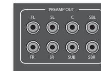
De analogische voorversterker uitgangen zijn gebufferd, hebben lage uitgangsimpedantie, zijn op lijnniveau en volgen de volumeregeling van zone 1. Indien noodzakelijk kunnen ze lange kabels of verschillende parallel aangesloten ingangen aansturen.
