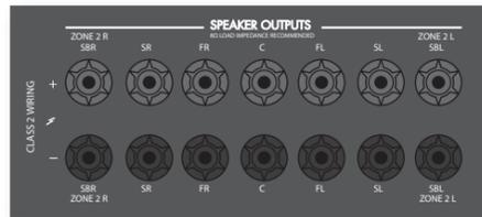
Важно, чтобы отдельные жилы провода из этих соединений не касались другого кабеля или корпуса устройства. Невыполнение этой инструкции может привести к короткому замыканию и повреждению вашего ресивера AVR750/450/380.
