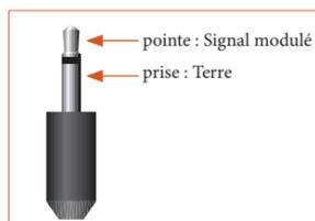
Les entrées infrarouge (**Z1 IR** et **Z2 IR**) permettent de brancher des récepteurs IR externes, soit lorsque le récepteur infrarouge de la façade de l'AV950/AVR750/450/380 est entièrement ou partiellement obstrué ou pour pouvoir utiliser une télécommande en Zone 2.
