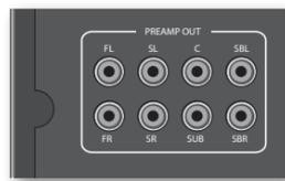
L'AVR950/AVR750/450/380 consente di collegare anche un subwoofer attivo all'uscita **SUB**. Consultare il manuale del subwoofer per la corretta impostazione e la procedura di collegamento per il vostro particolare subwoofer.
