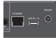
L'AV950/AVR750/450/380 è dotato di un client audio di rete che è in grado di riprodurre stazioni radio Internet così come la musica memorizzata su un dispositivo di archiviazione di rete, ad esempio un PC o un'unità flash USB.
