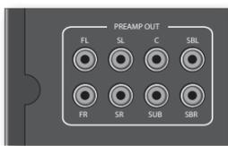
AV950/AVR750/450/380 还允许将有源低音炮连接到 **SUB** 输出接口。请参阅低音炮的手册，以了解特定低音炮的正确设置与连接步骤。
