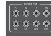
Toutes les sorties préamplificateur analogiques sont tamponnées, possèdent une faible impédance de sortie, sont de niveau ligne et sont alignées sur le réglage du volume de la Zone 1. Elles peuvent piloter de longs câbles ou plusieurs entrées en parallèle si nécessaire.
