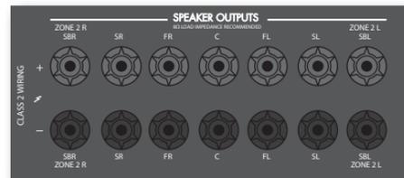
Если в главной области установлена система объемного звука 5.1 (не 7.1-канальная система), дополнительные выходы динамиков **SBL** и **SBR** можно использовать для питания динамиков в Зоне 2, поэтому усилитель не потребуется.
