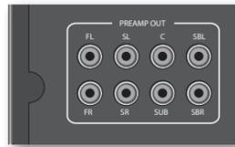
U kunt een actieve subwoofer aansluiten op de SUB uitgang van de AVR750/450/380. Raadpleeg de handleiding van uw subwoofer voor de correcte instelling en aansluiting van uw subwoofer.
