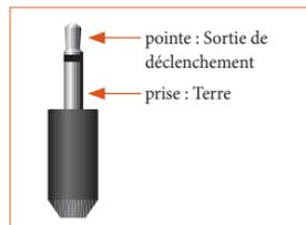
Les connecteurs de déclenchement (**TRIG Z1** et **TRIG Z2**) fournissent un signal électrique à chaque mise en marche de l'AV950/AVR750/450/380 et à chaque fois que la zone adéquate est activée.
