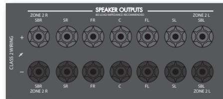
Wenn für die Haupt-Zone ein 5.1-Kanal Surroundton-Lautsprechersystem (kein 7.1-Kanal System) verwendet wird, können die SBL und SBR Reserve-Lautsprecheranschlüsse als Leistungslautsprecheranschlüsse in Zone 2 eingesetzt werden, so dass keine Endstufe erforderlich ist.
