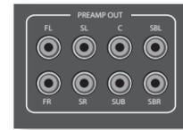
所有前置放大器模拟输出都已经过缓冲，其输出阻抗较低，采用线路电平，并遵照区域 1 的音量控制设置。如果需要，可以使用这些接口来驱动较长线缆或同时驱动多个输入。
