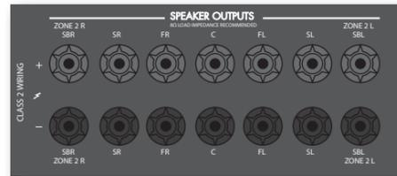
Si la zona principal tiene un sistema de altavoces con sonido envolvente con 5.1 canales (no un sistema con 7.1 canales), las salidas auxiliares de los altavoces SBL y SBR pueden utilizarse para potenciar los altavoces en la Zona 2, de manera que no se necesite un amplificador de potencia.
