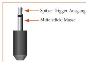
Die Triggeranschlüsse (**TRIG Z1** und **TRIG Z2**) geben ein elektrisches Signal aus, wenn der AV950/AVR750/450/380 eingeschaltet und die entsprechende Zone aktiviert wird.
