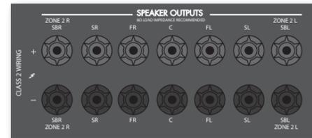
Als de primaire zone is voorzien van een 5.1-kanaals luidsprekersysteem (en geen 7.1-kanaals systeem), kunnen de ongebruikte luidsprekeruitgangen SBL en SBR worden gebruikt voor het voeden van luidsprekers in Zone 2. In dit geval is een vermogensversterker dus niet vereist.
