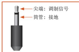
当 AV950/AVR750/450/380 前面板上的红外接收器被完全或部分阻挡时，或者要在区域 2 中使用遥控器时，可以通过红外输入接口（**Z1 IR** 和 **Z2 IR**）来连接外部红外接收器。
