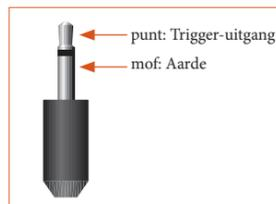
De trigger-connectoren (**TRIG Z1** en **TRIG Z2**) geven een elektrisch signaal als de AV950/AVR750/450/380 wordt aangezet en de desbetreffende zone is geactiveerd.
