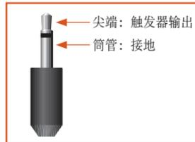
每当打开 AV950/AVR750/450/380 或者启用相关的区域时，触发器连接器（**TRIG Z1** 和 **TRIG Z2**）将会提供电信号。
