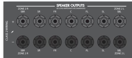
Se la zona principale ha un sistema di altoparlanti audio surround a 5.1 canali (non è un sistema a 7.1 canali), l'uscita SBL libera e le uscite dei diffusori SBR possono essere utilizzate per alimentare i diffusori nella Zona 2, in modo che non sia necessario un amplificatore di potenza.
