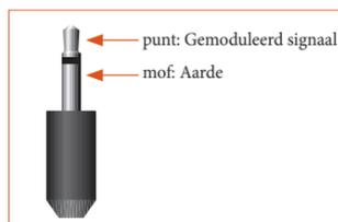
De infrarood ingangen (**Z1 IR** en **Z2 IR**) kunt u gebruiken voor de aansluiting van externe IR-ontvangers als de IR-ontvanger op het voorpaneel van de AV950/AVR750/450/380 gedeeltelijk of helemaal is afgedekt, of om een afstandsbediening te kunnen gebruiken in Zone 2.
